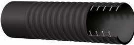
**Aspiration & Refoulement d'eau-lisier - Ondulé - Manchettes souples aux extrémités****Tube** : SBR noir.**Armature** : nappes textiles haute résistance renforcées avec des spirales métalliques en acier.**Revêtement** : SBR noir - résistant à l'abrasion et à l'ozone.**Utilisation** : l'aspiration et le refoulement d'eau.
