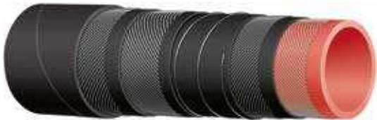
**Echantillonnage de minerai 35 bar (525 psi)****Tube** : NR rouge - résistant à l'abrasion**Armature** : nappes textiles haute résistance renforcées avec des spirales métalliques en acier.**Revêtement** : SBR/NR noir conducteur - résistant à l'abrasion et l'ozone.**Utilisation** : la récupération de minerai dans les opérations d'échantillonnage.**Températures d'utilisation** : -30 °C +80 °C (-22 °F +176 °F)
