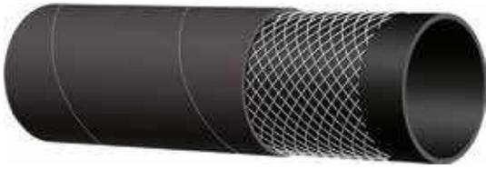
**Refoulement d'eau 5 bar (75 psi) - S'enroulant à plat****Tube :** EPDM noir.**Armature :** nappes textiles haute résistance.**Revêtement :** EPDM noir - résistant à l'abrasion et à l'ozone.**Utilisation :** le refoulement d'eau - enrroulement du tuyau à plat.**Températures d'utilisation :** -30 °C +80 °C (-22 °F +176 °F)
