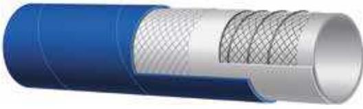
**Souffleur d'air chaud 10 bar (150 psi) - Hard Wall****Tube** : EPDM blanc - résistant à la chaleur.**Armature** : nappes textiles haute résistance renforcées avec des spirales métalliques en acier.**Revêtement** : EPDM bleu - résistant à la chaleur, l'abrasion et l'ozone.**Utilisation** : le raccordement d'air chaud du compresseur volumétrique au camion-citerne de produits pulvérulents alimentaires/pulvérulents en vrac.
