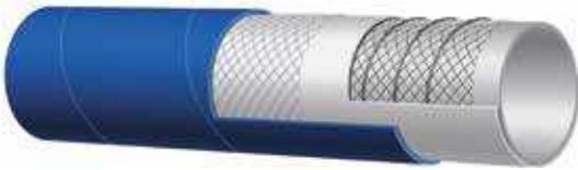
**Souffleur d'air chaud 10 bar (150 psi) - Hard Wall FDA****Tube** : EPDM blanc - résistant à la chaleur.**Armature** : nappes textiles haute résistance renforcées avec des spirales métalliques en acier.**Revêtement** : EPDM bleu - résistant à la chaleur, l'abrasion et l'ozone.**Utilisation** : le raccordement d'air chaud du compresseur volumétrique au camion-citerne de produits pulvérulents alimentaires/pulvérulents en vrac.
