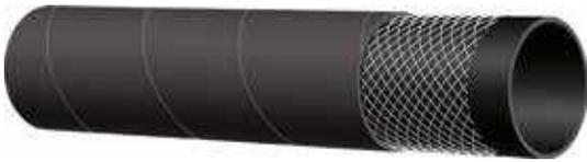
**Refoulement d'eau 10 bar (150 psi) - S'enroulant à plat****Tube :** EPDM noir.**Armature :** nappes textiles haute résistance.**Revêtement :** EPDM noir - résistant à l'abrasion et à l'ozone.**Utilisation :** le refoulement d'eau - enrroulement du tuyau à plat.**Températures d'utilisation :** -30 °C +80 °C (-22 °F +176 °F)
