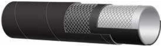
**Souffleur d'air chaud 10 bar (150 psi) - Soft Wall****Tube** : EPDM blanc - résistant à la chaleur.**Armature** : nappes textiles haute résistance.**Revêtement** : EPDM noir - résistant à la chaleur, l'abrasion et l'ozone.**Utilisation** : le raccordement d'air chaud du compresseur volumétrique au camion-citerne de produits pulvérulents alimentaires/pulvérulents en vrac.**Températures d'utilisation** : -40 °C +180 °C (-40 °F +356 °F)
