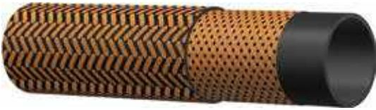
**Souffleur d'air chaud 10 bar (150 psi) - Soft Wall - Tresse externe textile****Tube** : EPDM noir - résistant à la chaleur.**Armature** : tresses textiles haute résistance.**Utilisation** : le raccordement d'air chaud du compresseur volumétrique au camion-citerne de produits pulvérulents alimentaires/pulvérulents en vrac.**Températures d'utilisation** : -40 °C +180 °C (-40 °F +356 °F)
