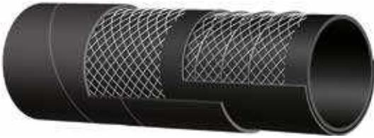
**Aspiration des eaux usées 5 bar (75 psi)****Tube :** NR noir conducteur - résistant à l'abrasion.**Armature :** nappes textiles haute résistance renforcées avec des spirales métalliques en acier.**Revêtement :** SBR/NR noir conducteur - résistant à l'abrasion et l'ozone.**Utilisation :** enrouleur horizontal pour le nettoyage des égouts et les véhicules d'aspiration des déchets.
