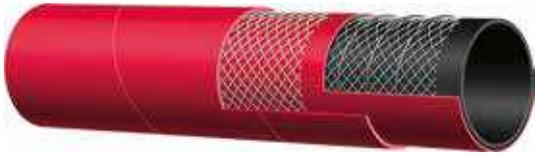
**Aspiration & Refoulement d'hydrocarbures 10 bar (150 psi)****Tube :** NBR noir conducteur.**Armature :** nappes textiles haute résistance renforcées avec des spirales métalliques en acier.**Revêtement :** CR rouge - résistant à l'abrasion, l'ozone et les hydrocarbures.**Utilisation :** l'aspiration et le refoulement de carburant et d'huile. Spécialement conçu pour les camions-citernes et les applications industrielles générales.**Températures d'utilisation :** -30 °C +80 °C (-22 °F +176 °F)
