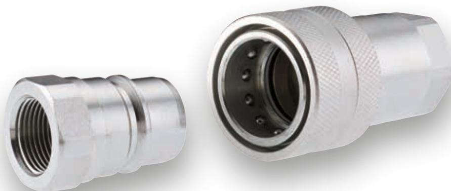
Os acoplamentos rápidos ARGUS da série ISO 7241-1 “A” são usados para o engate e o desengate rápido de tubulações hidráulicas. Durante a operação de acoplamento em instalações de baixa pressão ou pressão zero, as válvulas que liberam ou bloqueiam o fluxo são automaticamente ativadas. O acoplamento rápido SVK-ISO-A SS, formado pelo pino e o bocal de acoplamento, é encaixado pressionando uma luva. Isso garante uma conexão nivelada entre as duas partes de acoplamento.
