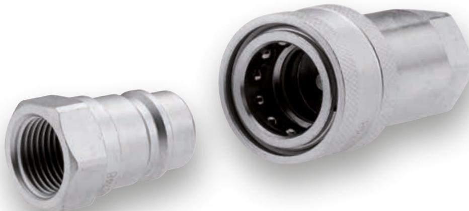
Os acoplamentos rápidos ARGUS da série ISO 7241-1 "A" são usados para o engate e o desengate rápido de tubulações hidráulicas. Durante a operação de acoplamento em instalações de baixa pressão ou pressão zero, as válvulas que liberam ou bloqueiam o fluxo são automaticamente ativadas. O acoplamento rápido SVK-ISO-A, formado pelo pino e o bocal de acoplamento, é encaixado pressionando uma luva. Isso garante uma conexão nivelada entre as duas partes de acoplamento.
