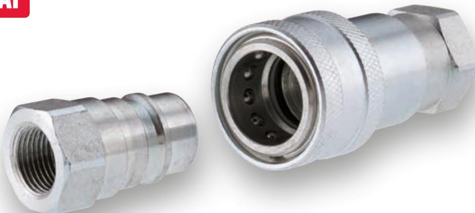
Os acoplamentos ARGUS SHK são usados para o engate e o desengate rápido de tubulações hidráulicas. Durante a operação de acoplamento em instalações de baixa pressão ou pressão zero, as válvulas que liberam ou bloqueiam o fluxo são automaticamente ativadas.
