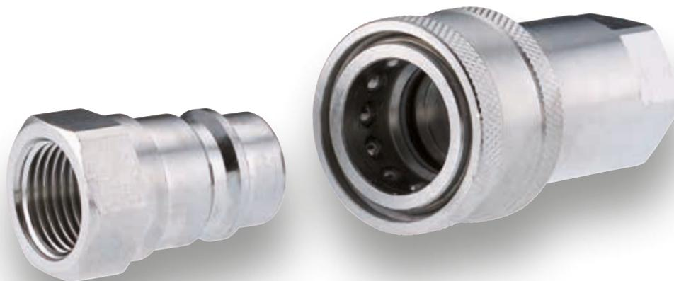
Os acoplamentos rápidos ARGUS Agrícolas/ Normais com válvula de esfera são usados para o engate e o desengate rápido de tubulações hidráulicas. Durante a operação de acoplamento em instalações de baixa pressão ou pressão zero, as válvulas que liberam ou bloqueiam o fluxo são automaticamente ativadas. O acoplamento rápido SNK-B, formado pelo pino e o bocal de acoplamento, é encaixado pressionando uma luva.
