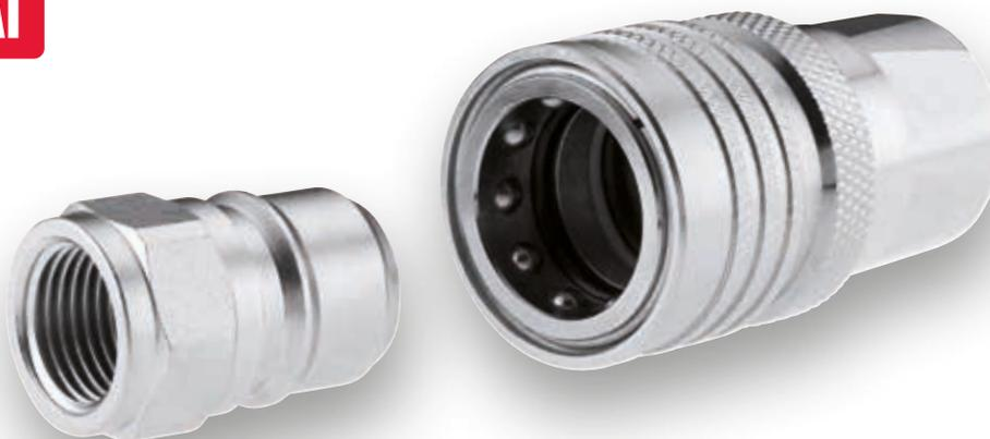
Os acoplamentos ARGUS SLK são usados para o engate e o desengate rápido de tubulações hidráulicas. Durante a operação de acoplamento em instalações de baixa pressão ou pressão zero, as válvulas que liberam ou bloqueiam o fluxo são automaticamente ativadas.
