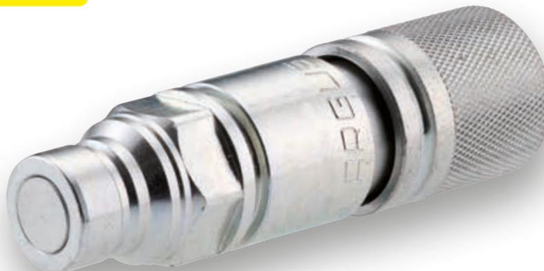
Os adaptadores de engate rápido ARGUS conectáveis sob pressão realizam uma conexão fácil e confiável entre acoplamentos fêmea de válvula de gatilho ISO 7241 A e macho de face plana ISO 16028 ou entre acoplamentos fêmea de face plana ISO 16028 e macho de válvula de gatilho ISO 7241 A.
