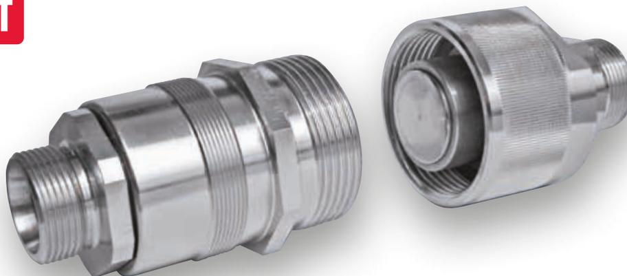
Os acoplamentos para alta pressão ARGUS RPK podem ser usados para conectar e desconectar tubulações hidráulicas. O modelo nivelado da válvula reduz ao mínimo o vazamento de fluido durante a conexão e a desconexão. Sua construção sólida e seus componentes testados fazem com que sejam ideais para cargas de pressão elevadas e intermitentes. Durante a operação de acoplamento, as válvulas que liberam e/ou bloqueiam o fluxo são automaticamente ativadas.
