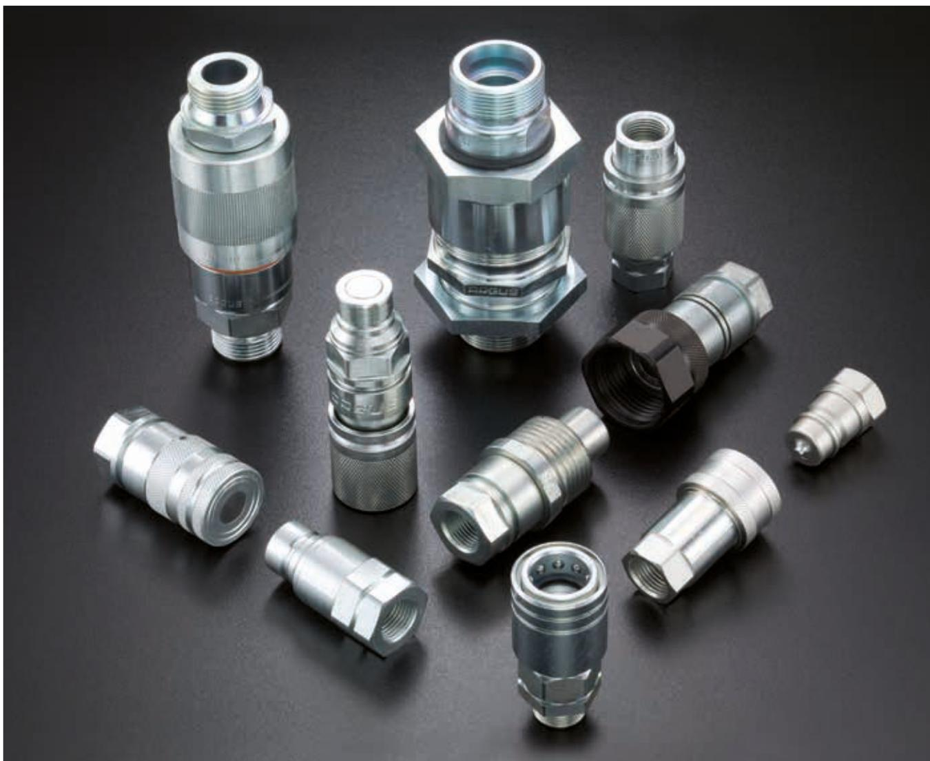
Para a conexão rápida e fácil de mangueiras hidráulicas, a linha Alfagomma de componentes para fluidos inclui a série ARGUS de acoplamentos de desconexão rápida, com produtos em conformidade com os padrões internacionais ISO 7241-1 A & B, ISO 5675 e ISO 16028, com válvula de gatilho e face plana, respectivamente. O design padronizado garante a completa intercambiabilidade com acoplamentos equivalentes atualmente em uso.
