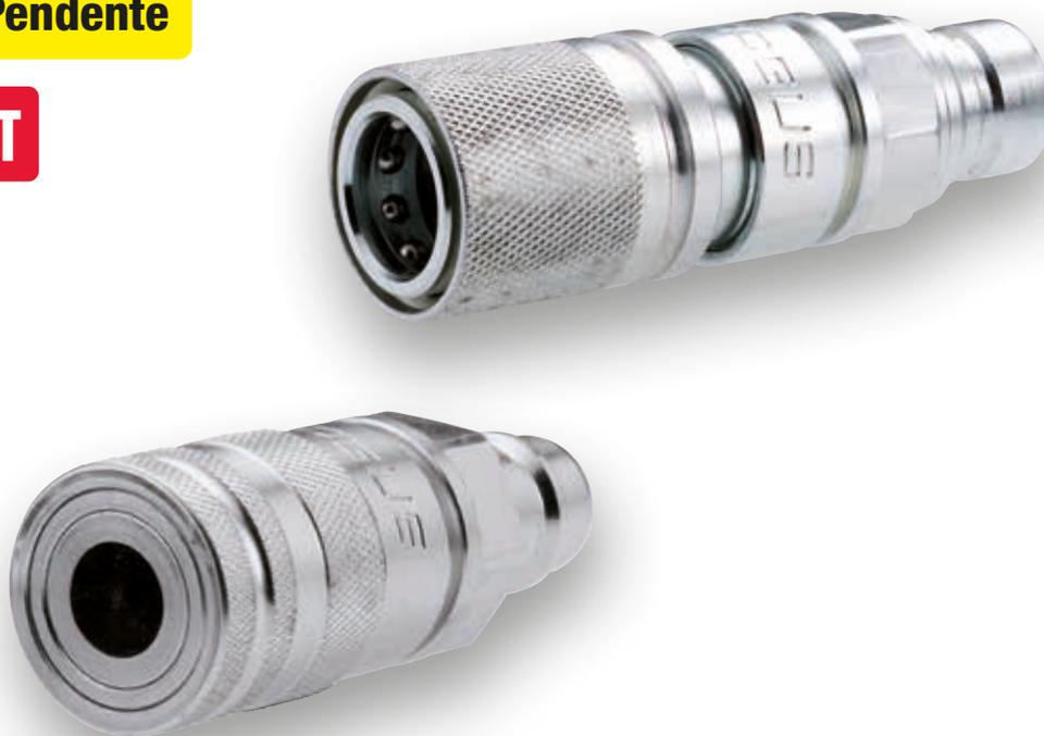
Os adaptadores de engate rápido ARGUS realizam uma conexão fácil e confiável entre acoplamentos fêmea de válvula de gatilho ISO 7241 A e macho de face plana ISO 16028 ou entre acoplamentos fêmea de face plana ISO 16028 e macho de válvula de gatilho ISO 7241 A. Isso permite que o usuário adapte uma peça de engate rápido já existente ao novo tipo de conexão.
